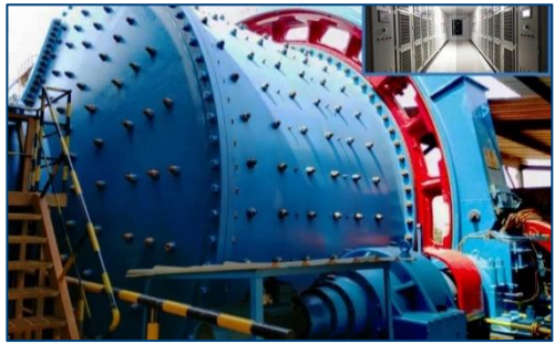
10MW级同步电机专用变频器驱动矿山双驱半自磨机
